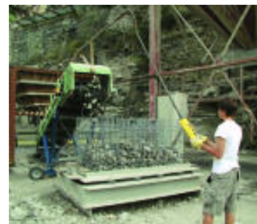
Füllanlage mit Rütteltisch
